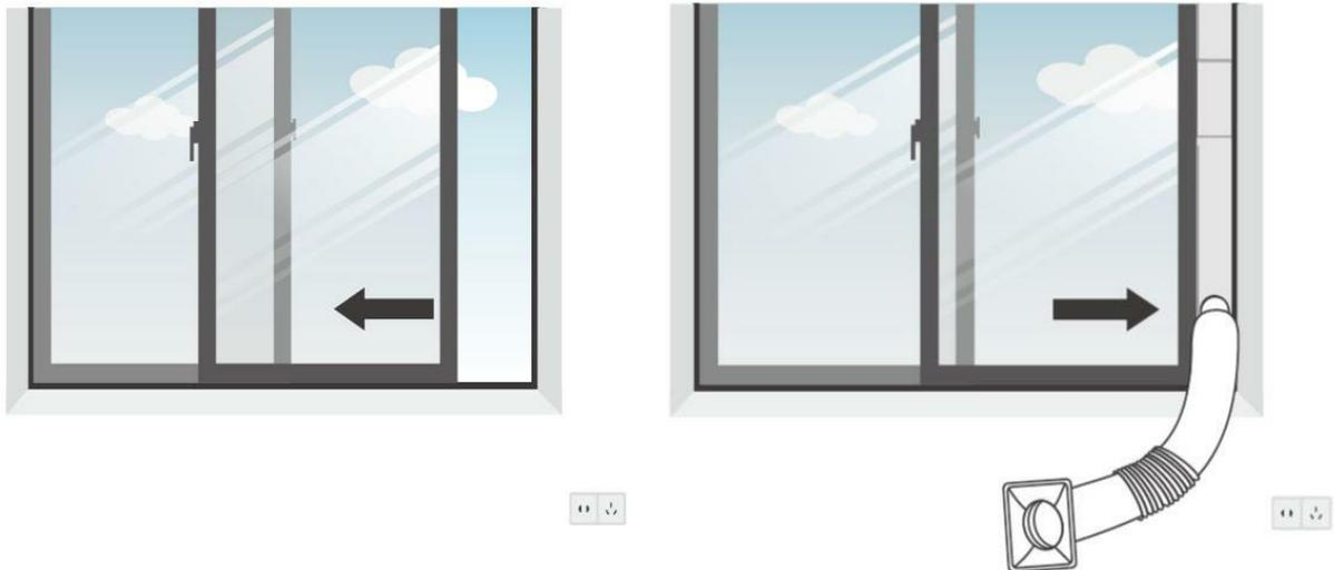
Hier können Sie nun, wie unter Punkt 8.2 gezeigt, das Klimagerät anschließen und die Luft nach außen leiten.
